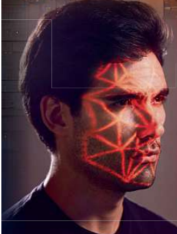
Bei der KI-gestützten Gesichtserkennung lokalisieren Algorithmen ein menschliches Gesicht auf einem Bild. Die Identifikation erfolgt dann durch die Analyse der Daten.
