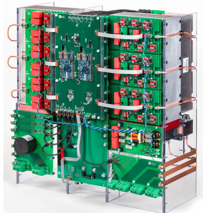
Bild 4: Dreiphasiger 1,5 kV<sub>AC</sub> / 250 kVA PV-Wechselrichter
