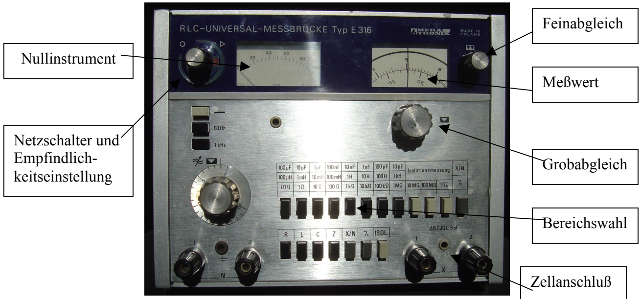
Bedienelemente der RCL-Meßbrücke
